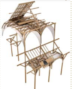
A gauche : modèle de la structure de support Ci-dessus : détail des systèmes de renforcement structural. Un système complexe de tirants en acier a été conçu à l'aide de modèles mathématiques, afin de renforcer les poutres et la structure supérieure.
